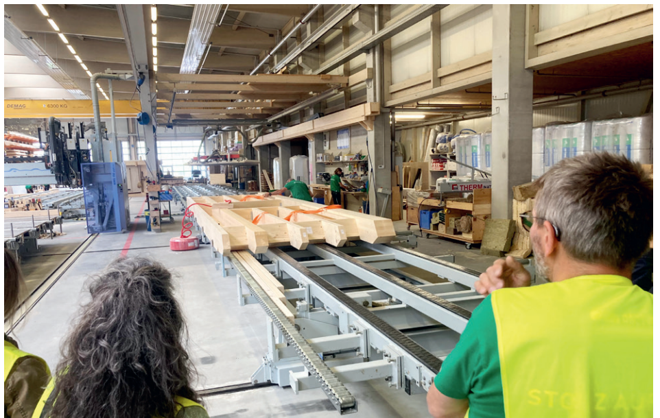
Das Holzelement wird auf Schienen zur nächsten Station befördert.
